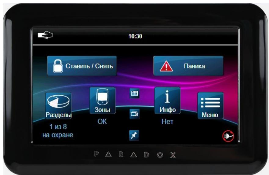
Постановка на охрану/снятие с охраны — Нажать кнопку «Ставить/Снять», появится окно, в котором необходимо нажать кнопку, соответствующую выбранному способу постановки на охрану или снятию с охраны.
