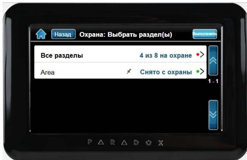
Если Ваш инсталлятор активировал функцию быстрой постановки на охрану, после выбора разделов, начнется отсчет задержки на выход.
